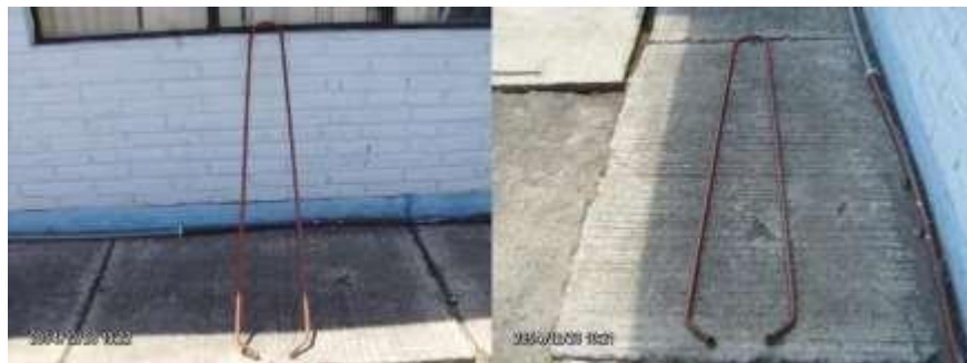
Fig. 3 Vincha para asegurar carro de aforo
